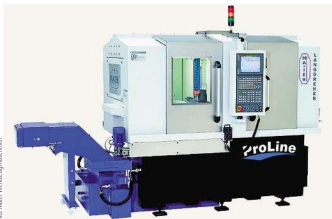
Die Maschine gibt es als reinen Langdreher und als Lang-Kurzdreher, der vom Langdreher innerhalb von 20 Minuten in eine Kurzdrehmaschine verwandelt werden kann.
