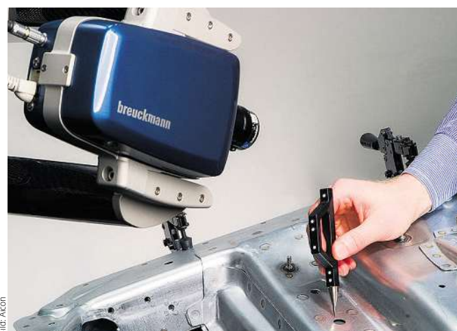
Der Messtaster ist mit Messpunkten versehen, die von der Kamera des Scanners erkannt werden.
